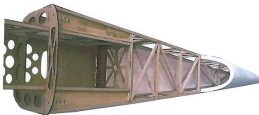
Figura 3-3 - Estrutura de cauda treliçada no Extra 330-S 40%
