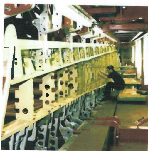
Figura 3-14 - Detalhe das nervuras e longarinas do Airbus A380
