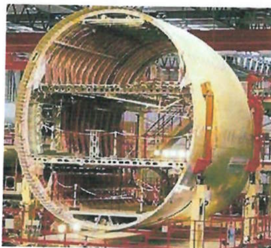
Figura 3-1 - Seção transversal do Airbus A380
